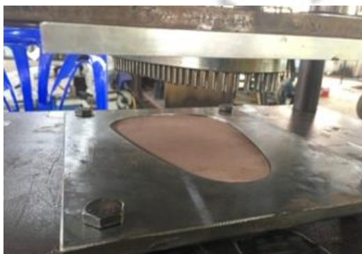
ภาพที่ 7 ลักษณะการเจาะรูชิ้นส่วนหมวกควาบอยด้วยเครื่องเจาะรูชิ้นส่วนหมวกควาบอยส่วนหัวหมวก
