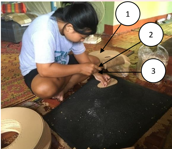
ภาพที่ 1 การเจาะรูชิ้นส่วนหมวกควาบอยด้วยการตอกจากแรงงานคน
