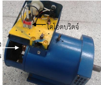
ข. ส่วนของไดโอดบริดจ์ สลิปริง และแปรงถ่าน
