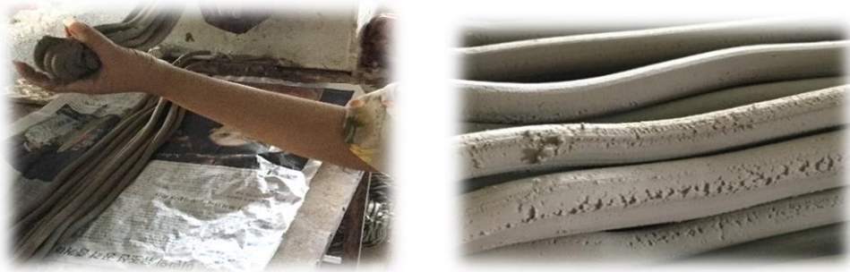
ภาพที่ 4 การรีดดินผ่านเครื่องรีดให้เป็นเส้น มีรอยแตกบริเวณผิวด้านนอกของเส้นดินที่รีดออกมา
