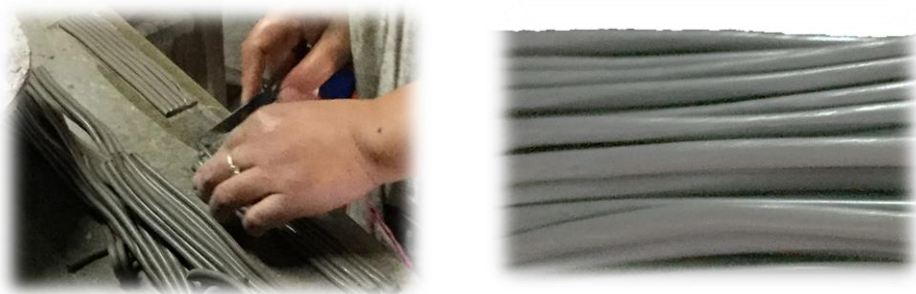
ภาพที่ 6 ลักษณะเนื้อดินที่รีดเป็นเส้นและใช้ผ้าที่มีความชื้นคลุมทิ้งไว้ 1 คืนก่อนนำมาปั้นขึ้นรูปตะกร้าสานบริเวณผิวด้านนอกของเส้นดินไม่พบรอยแตก
