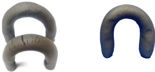
ภาพที่ 4 การรีดดินผ่านเครื่องรีดให้เป็นเส้น มีรอยแตกบริเวณผิวด้านนอกของเส้นดินที่รีดออกมา
