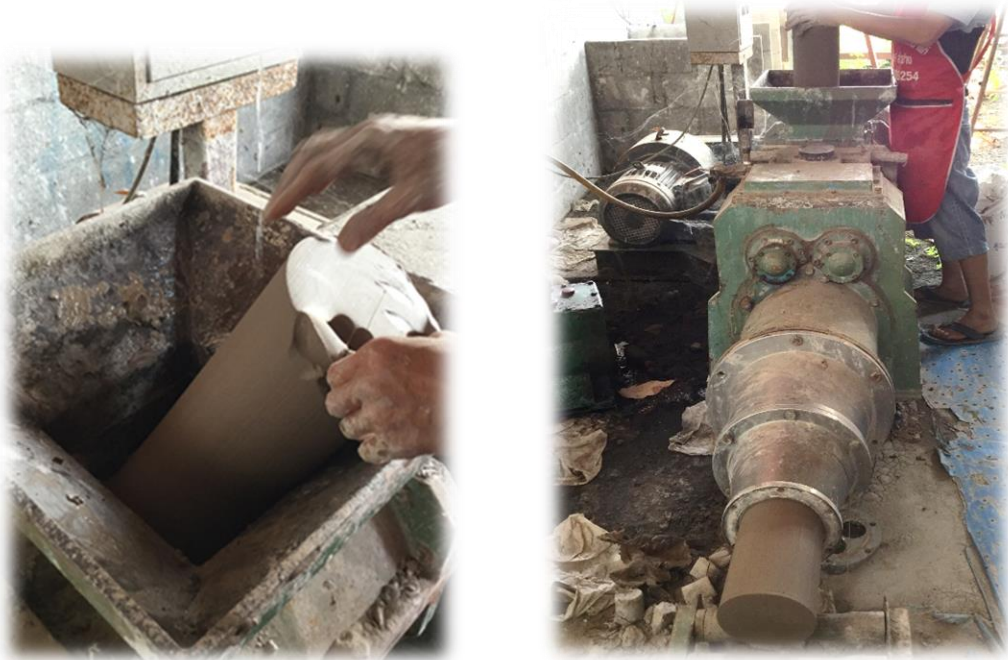
ภาพที่ 2 การเตรียมเนื้อดินปั้นของโรงงานจำปาเซรามิก ด้วยการใช้เครื่องนวดดินแบบสุญญากาศ
