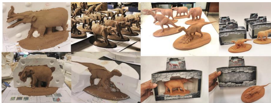
ภาพที่ 6 กระบวนการผลิตชิ้นงานด้วยน้ำดินหล่อด่านเกวียน พร้อมการออกแบบบรรจุภัณฑ์
