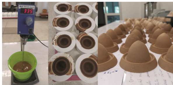
ภาพที่ 2 ผสมวัตถุดิบทั้งหมดลงในเครื่องกวนผสม และนำไปหล่ลงในแม่พิมพ์ปูนปลาสเตอร์
