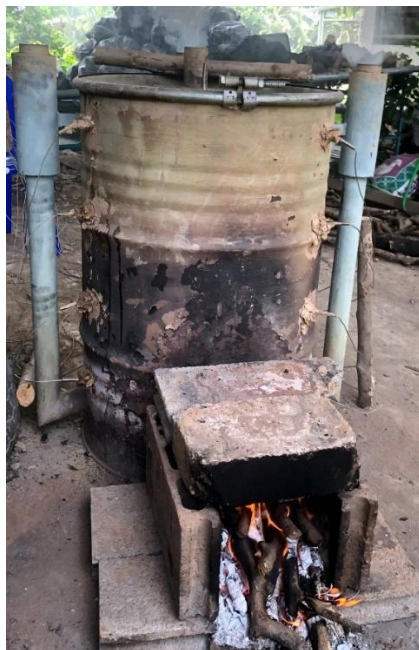
ภาพที่ 2 กระบวนการเผาถ่านจากวัสดุเหลือทิ้งด้วยเตาเผาถ่าน ขนาด 200 ลิตรแบบตั้ง
