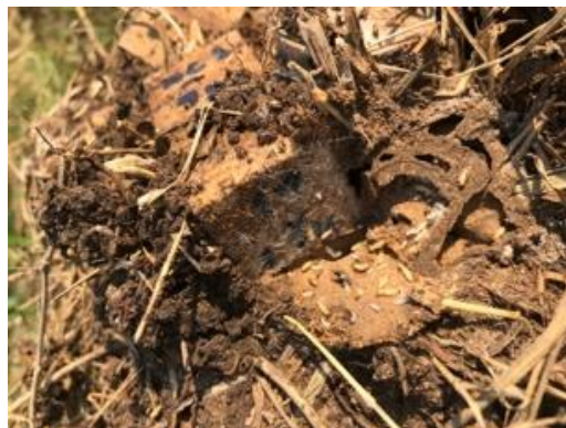
ภาพที่ 4 นำตัวอย่างทดลองที่ผ่านการแช่สารสกัดสมุนไพร ไปใส่ลงในจอมปลวกเป็นเวลา 1 เดือน
