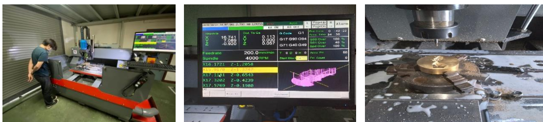
ภาพที่ 5 การผลิตแม่พิมพ์ปั๊มสบู่มุมนไพโรโดยใช้เครื่องกัดซีเอ็นซี
