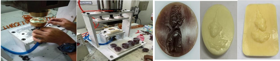
ภาพที่ 8 ประกอบและติดตั้งแม่พิมพ์บนเครื่องปั๊มสบู่
