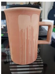
ภาพที่ 9 เคลือบเอนโกบดินเลน
