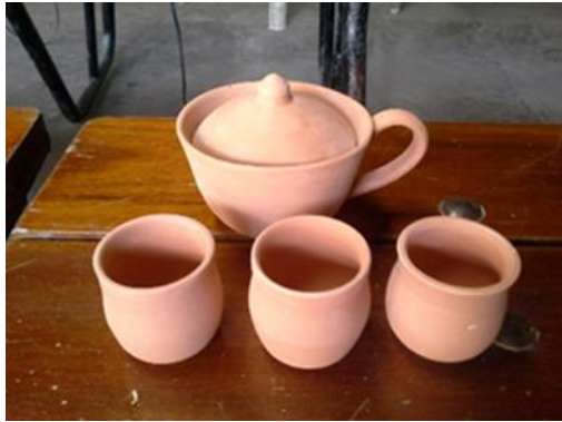
ภาพที่ 7 การขึ้นรูปถ้วยชาจากดินเลนด้วยการขึ้นรูปด้วยแป้นหมุน เผาที่อุณหภูมิ 1100 °C
