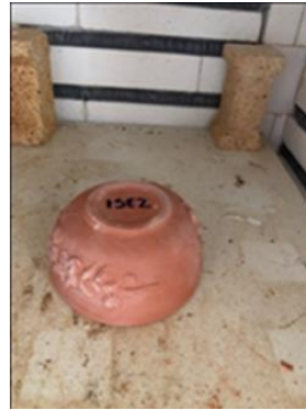
ภาพที่ 8 ตัวอย่างชิ้นงานขึ้นรูปด้วยจิกเกอร์ หลังเผาที่อุณหภูมิ 1100°C
