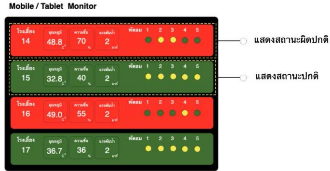
ภาพที่ 2 การรายงานข้อมูลความชื้น อุณหภูมิ ระดับแรงดันน้ำในท่อ และการระบายอากาศจากพัดลมในโรงเลี้ยงไก่
