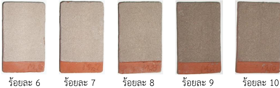
ภาพที่ 6 แท่งทดสอบน้ำดินสีพื้นฐาน เติมสารให้สีแมงกานีสไดออกไซด์
