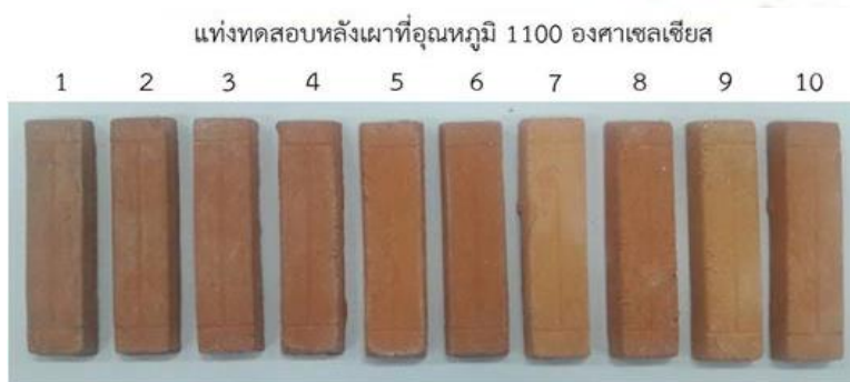
ภาพที่ 2 แท่งทดสอบหลังเผาที่อุณหภูมิ 1100 องศาเซลเซียส
