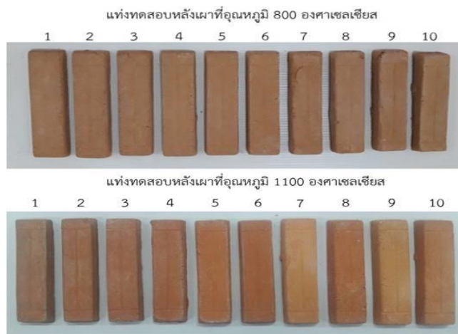
ภาพที่ 1 แท่งทดสอบหลังเผาที่อุณหภูมิ 800 และ 1100 องศาเซลเซียส
