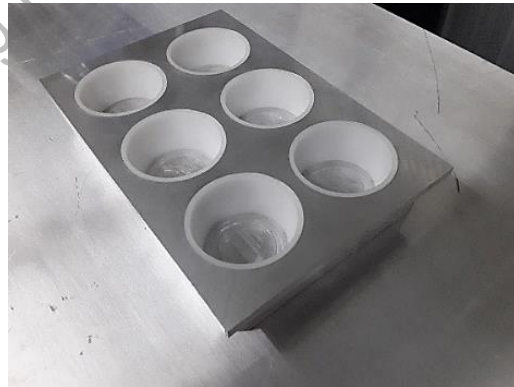
ภาพที่ 4 แสดงแม่พิมพ์สำหรับขึ้นพลาสติกแผ่นด้วยเครื่องขึ้นรูปพลาสติกด้วยความร้อน
