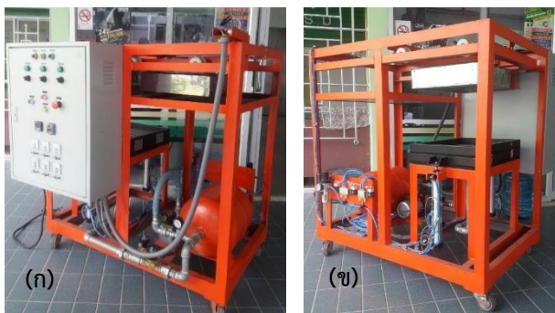
ภาพที่ 2 แสดงเครื่องขึ้นรูปพลาสติกด้วยความร้อน (ก) ด้านหน้าของเครื่อง (ข) ด้านหลังของเครื่อง
