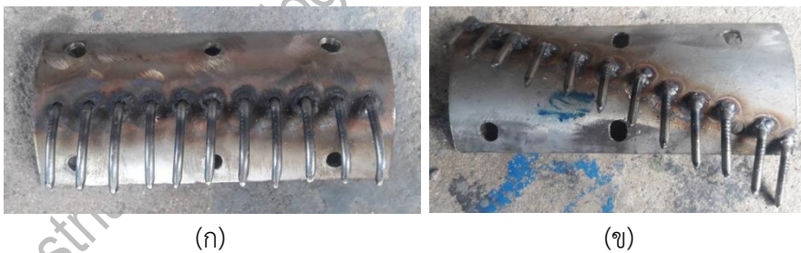
ภาพที่ 2 ลักษณะการเรียงตัวของใบมีด (ก) ใบมีดแบบเรียงตรง (ข) ใบมีดแบบเรียงเฉียง
