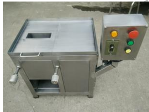
ภาพที่ 5 เครื่องฉีกหมูฝอย (ก) แบบเครื่องต้นแบบด้วยโปรแกรม CAD (ข) เครื่องฉีกเส้นหมูฝอยต้นแบบ
