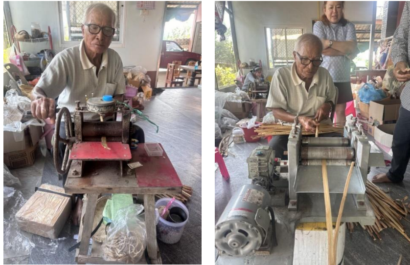
ภาพที่ 5 เครื่องรีดฝักตบชาแบบมือหมุน (ซ้าย) และเครื่องรีดฝักตบชาแบบใช้มอเตอร์ไฟฟ้า (ขวา)
