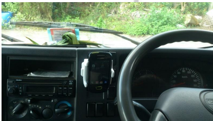
ภาพที่ 4 การติดตั้งสมาร์ทโฟนในรถขนส่งที่ต้องการติดตาม
