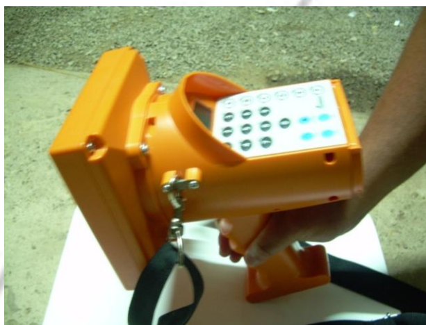
ภาพที่ 6 แสดงรูปเครื่องรีดเดอร์ (RFID Reader)แบบมือถือจัดเก็บข้อมูล
