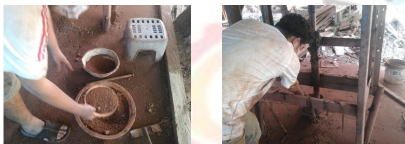
ภาพที่ 5 แสดงการย่อยแร่และการคัดขนาดแร่เหล็กน้ำพี้ในปัจจุบัน
