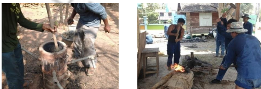
ภาพที่ 3 แสดงการผลิตเหล็กน้ำพี้ ขั้นตอนกิจกรรมกลางน้ำในการถลุงแร่เหล็กน้ำพี้
