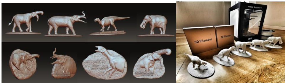
ภาพที่ 5 ผลงานการสร้างต้นแบบ 3 มิติจากโปรแกรมคอมพิวเตอร์ซีบรัช (ZBrush) และผลงานการสร้างต้นแบบด้วยเครื่อง เครื่องพิมพ์ 3D Printer
