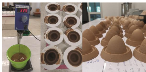
ภาพที่ 2 ผสมวัตถุดิบทั้งหมดลงในเครื่องกวนผสม และนำไปหล่อลงในแม่พิมพ์ปูนปลาสเตอร์
