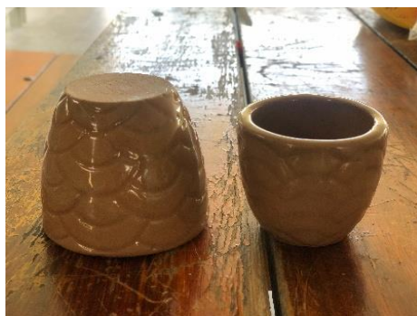
ภาพที่ 7 การทดลองเผาเคลือบขาวใส่ให้กับผลิตภัณฑ์ผลิตภัณฑ์เซรามิกทั้งขนาดเล็ก
