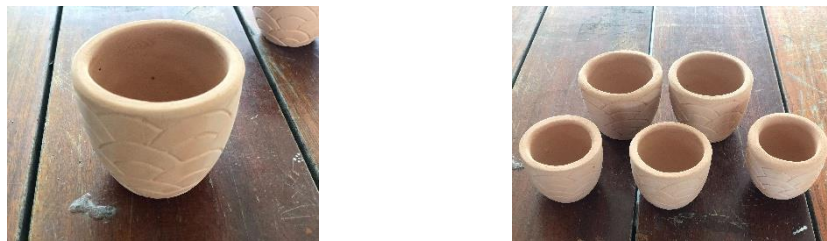
ภาพที่ 6 ผลิตภัณฑ์หลังเผาปัสกิต ที่อุณหภูมิ 750 °C ที่มีสีน้ำตาลอ่อน ผิวเรียบ มีลวดลายคมชัด และมีความแข็งแรง รูปทรงสมมาตรและไม่มีการบิดเบี้ยว
