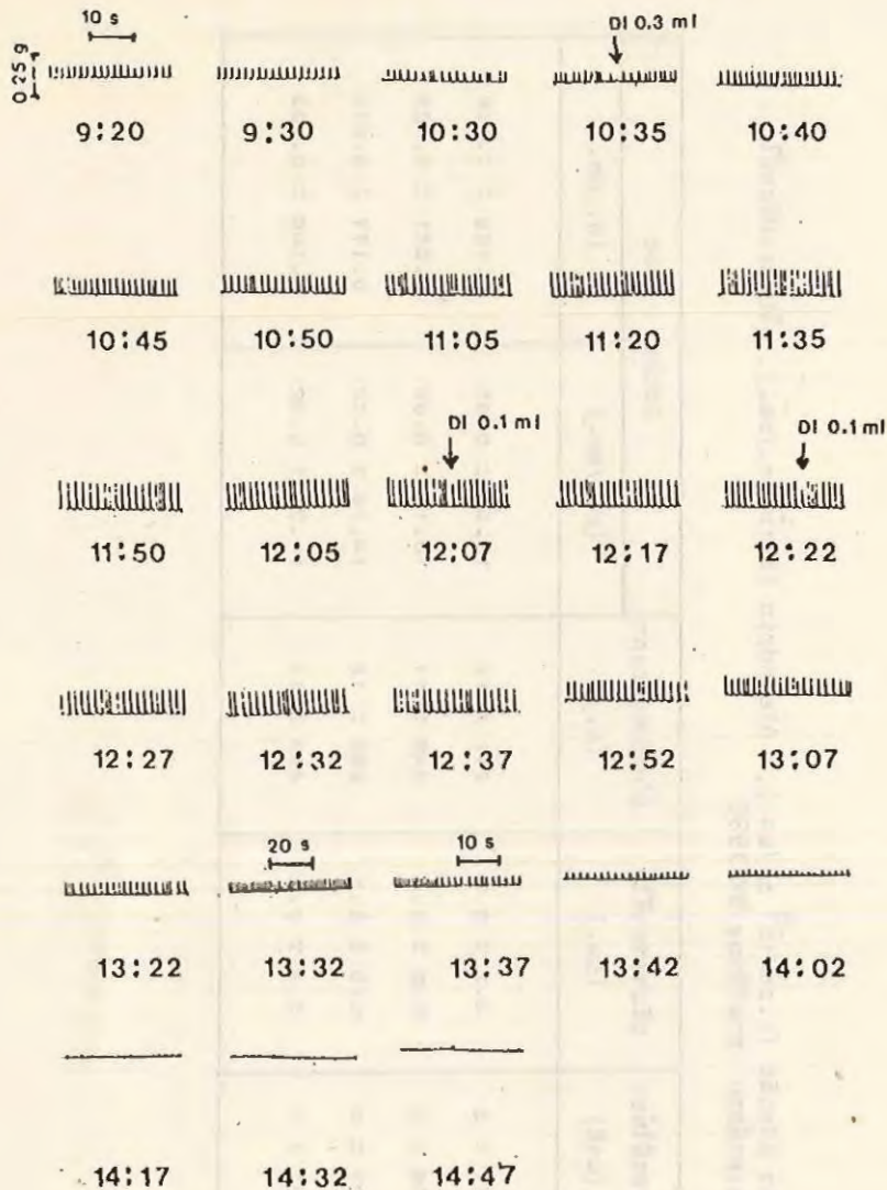
รูปที่ 5 ตัวอย่างการบันทึกผลแสดงฤทธิ์ของผงน้ำสกัดแห้งละลายน้ำของดิจิตาลิสมาตรฐาน (digitalis powder DAB 8 ความเข้มข้นน้ำยาที่ใช้ 5 มก./มล.) ต่อการเปลี่ยนแปลงแรงบีบตัวของ right ventricular strip ของหนูตะเภาที่เวลาต่าง ๆ
