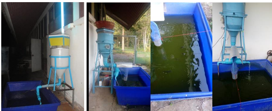
ภาพที่ 3 รูปร่างลักษณะของเครื่องให้อาหารปลาด้วยกับดักเครื่องดูดแมลงบินอัตโนมัติ และลักษณะของบ่อเลี้ยงปลา
