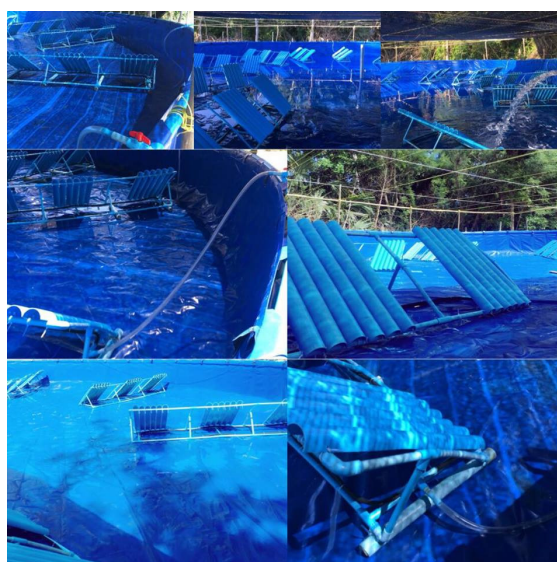
ภาพที่ 2 การจัดวางท่อDiffuser ตามรูปแบบที่ผู้วิจัยพัฒนาขึ้น (ชุดการทดลองที่ 2)
