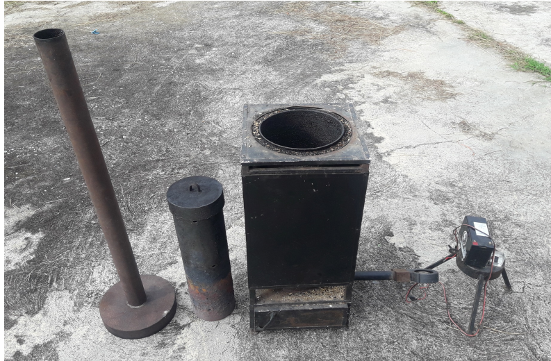
ภาพที่ 2 ลักษณะของเตาประดิษฐ์สำหรับการเผาถ่านจากเศษกะลามะคาเดเมียที่ใช้ในการศึกษา
