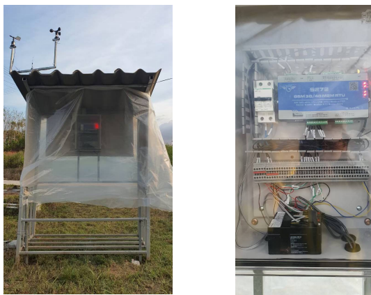
ภาพที่ 6 สถานีเก็บข้อมูลทางอุตุนิยมวิทยาแบบเฉพาะพื้นที่และบันทึกข้อมูลตามเวลาจริง (Real time)
