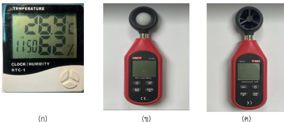
ภาพที่ 2 (ก) เครื่องวัดอุณหภูมิอากาศและความชื้นสัมพัทธ์ (ข) เครื่องวัดความเข้มแสง (ค) เครื่องวัดความเร็วลม
