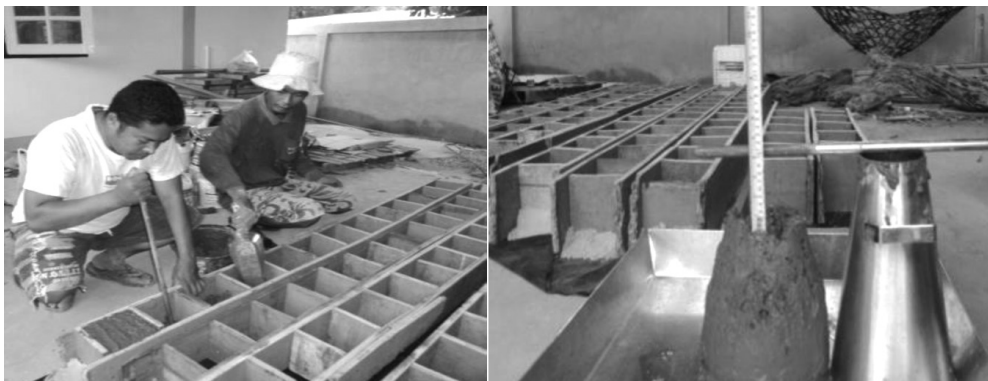
ภาพที่ 1 การหล่อตัวอย่างคอนกรีตทรงลูกบาศก์ (Cube) ขนาด 15x15x15 เซนติเมตร และทดสอบค่าการยุบตัว(Slump Test)
