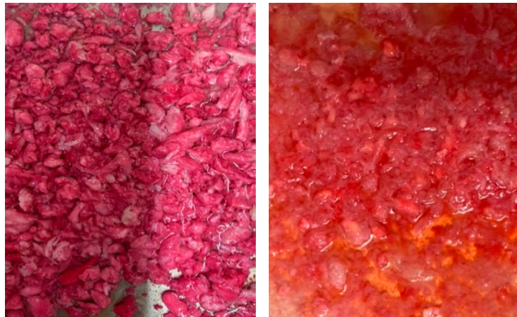
(ก) ใช้น้ำ RO เป็นสารทำความสะอาด (ข) ใช้สารละลายโซเดียมไฮดรอกไซด์ เป็นสารทำความสะอาด
