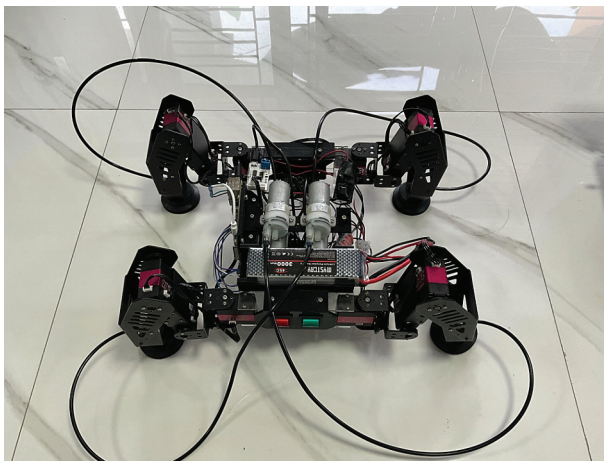
ภาพที่ 2 หุ่นยนต์ตรวจสอบสภาพใบกังหันลมผลิตไฟฟ้า
