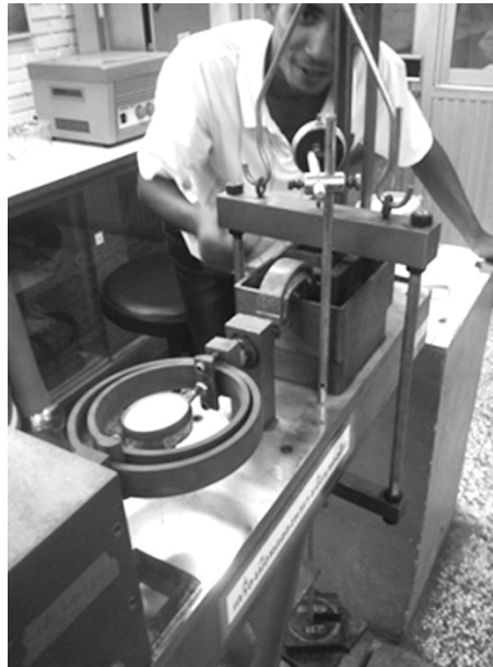
รูปที่ 8 การทดสอบแรงเฉือนตรง
