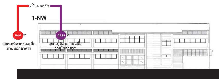
ภาพที่ 13 สรุปผลการเปรียบเทียบอุณหภูมิอากาศกลางวันของผนังอาคารด้าน 1-NW
