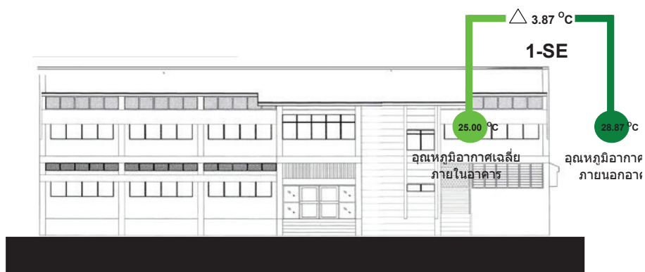
ภาพที่ 11 สรุปผลการเปรียบเทียบอุณหภูมิอากาศเฉลี่ยกลางวันของผนังอาคารด้าน 1-SE
