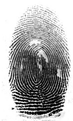
ภาพรอยลายนิ้วมือที่ปรากฏบนพื้นผิว หลังจากการชุบโลหะด้วยไฟฟ้า
