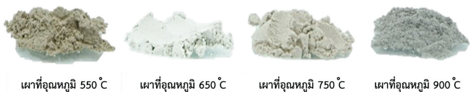
ภาพที่ 3 ซีเมนต์เคลือบหลังการชะล้างด้วยกรดแล้วนำไปเผาที่อุณหภูมิต่าง ๆ เป็นเวลา 6 ชั่วโมง
