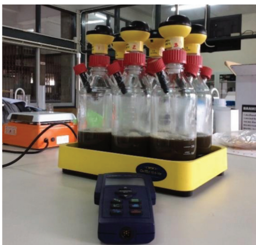
ภาพที่ 6 การศึกษาการผลิตก๊าซชีวภาพจากน้ำทิ้งจากตะกอนทั้งที่ผ่านและไม่ผ่านการปรับสภาพด้วยโอโซนทดลองใน OxiTop® Control OC 110 Respirometer
