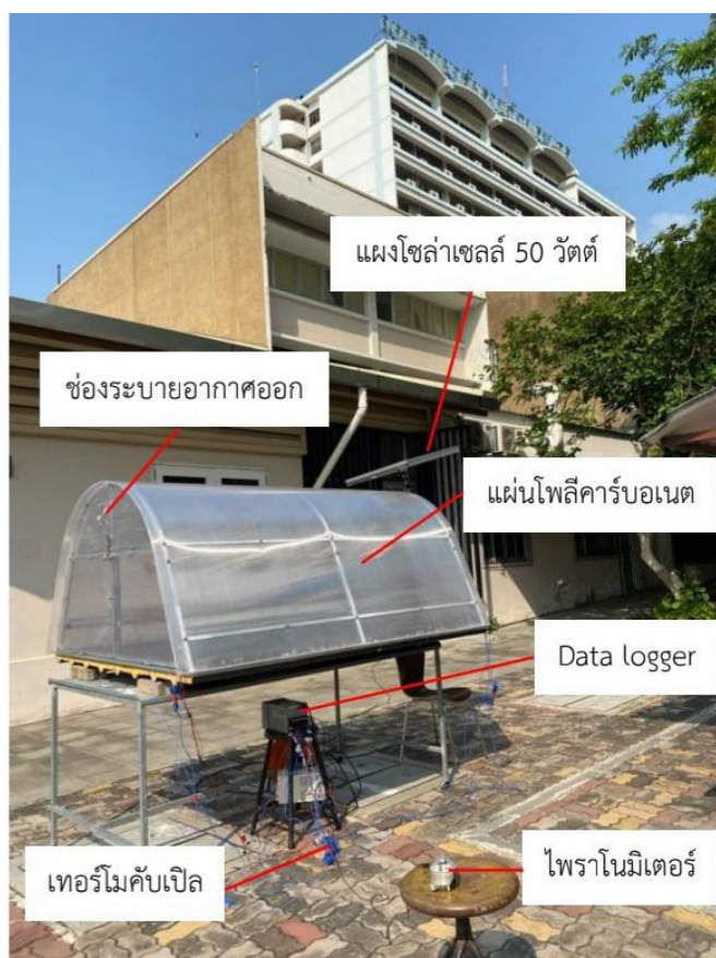
ภาพที่ 1 เครื่องอบแห้งพลังงานอาทิตย์ขนาด 1.5 x 2.0 ตารางเมตร ที่มีระบบควบคุมอุณหภูมิอากาศด้วยเทอร์โมสแตท
