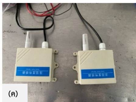
ภาพที่ 5 แสดงเครื่องมือวัด (ก) ไพราโนมิเตอร์ยี่ห้อ Kipp & Zonen รุ่น CM 11 (ข) เทอร์โมคัปเปิล ชนิด K (ค) ไฮโกรมิเตอร์ยี่ห้อ ZTS-3002-WS-V05 (ง) เครื่องบันทึกข้อมูลเชิงตัวเลข ยี่ห้อ EURO THERM CHESSELL รุ่น 6100A
