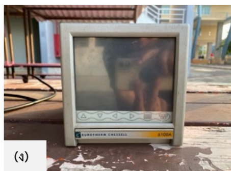
ภาพที่ 5 แสดงเครื่องมือวัด (ก) ไพราโนมิเตอร์ยี่ห้อ Kipp & Zonen รุ่น CM 11 (ข) เทอร์โมคัปเปิล ชนิด K (ค) ไฮโกรมิเตอร์ยี่ห้อ ZTS-3002-WS-V05 (ง) เครื่องบันทึกข้อมูลเชิงตัวเลข ยี่ห้อ EURO THERM CHESSELL รุ่น 6100A
