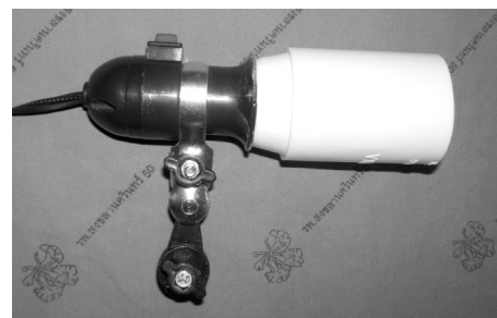
รูปที่ 7 ใช้กาวตราช้างยึดขวดพลาสติกให้ติดกับโคมไฟ
