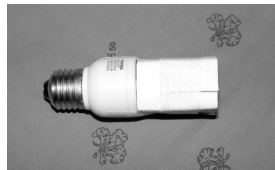
รูปที่ 5 ใช้กระดาษแข็งพันรอบหลอดประหยัดไฟ
