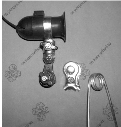
รูปที่ 4 ถอดข้อต่อที่ยึดขาหนีบออกและประกอบน็อตเข้าตามรูป
