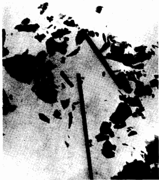
รูปที่ 1 ภาพถ่ายจากกล้องจุลทรรศน์อิเล็กตรอนแบบส่องกราด (TEM) แสดงให้เห็นผลึกรูปร่างหลายชนิดที่เป็นส่วนประกอบของกระเบื้องแผ่นเรียบ กำลังขยาย 5,700 เท่า
