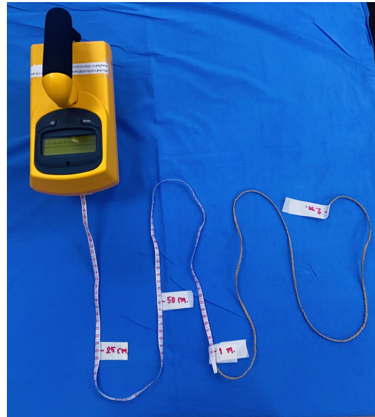
รูปที่ 1 เครื่องวัดรังสี survey meter ที่ติดสายวัด และสัญลักษณ์บอกตำแหน่งที่ระยะต่าง ๆ
