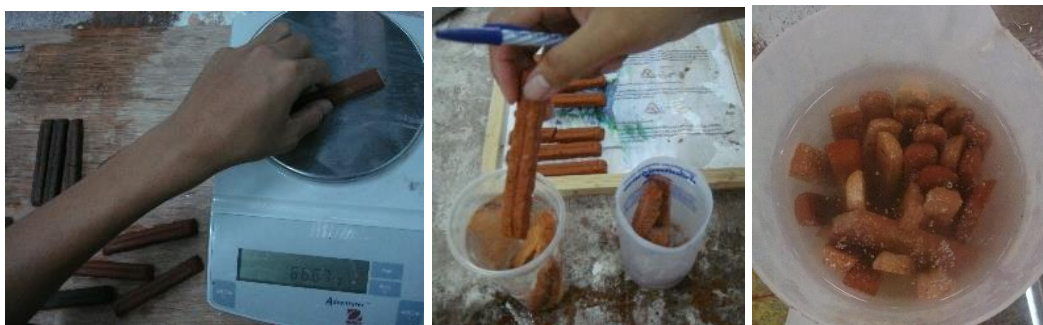
รูปที่ 6 แสดงแท่งทดสอบที่ผ่านการเผาและหาการดูดซึมน้ำ
