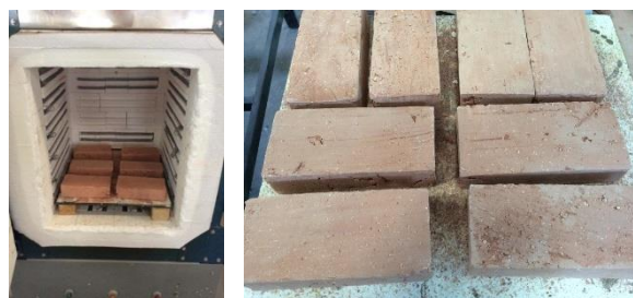
รูปที่ 11 การเผาแห้งทดสอบวัสดุซึบน้ำที่อุณหภูมิ 700 องศาเซลเซียส
