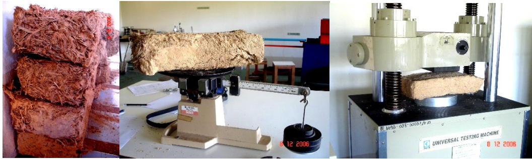
รูปที่ 1 การทดสอบกำลังรับแรงอัดของอิฐดินดิบ
