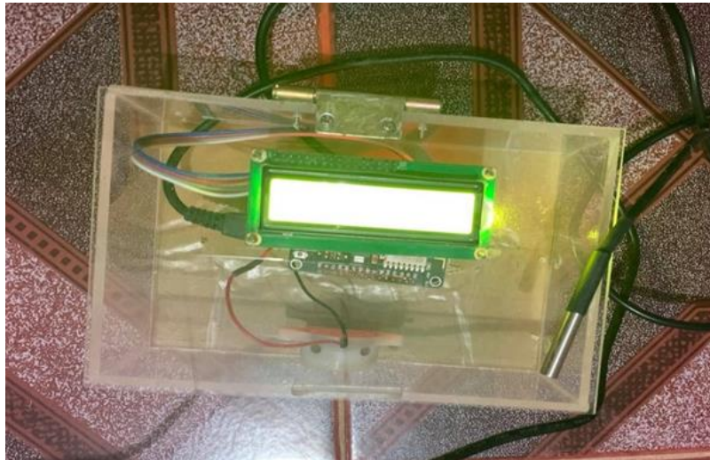
ภาพที่ 3 ฮาร์ดแวร์สำหรับควบคุมการทำงานของระบบตู้เก็บวัคซีนด้วยอาร์ดุยโน
