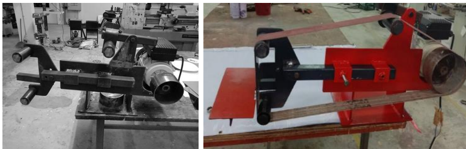
ภาพที่ 1 เครื่องขัดกระดาษทรายแบบสายพานที่ได้ออกแบบสร้างขึ้น
