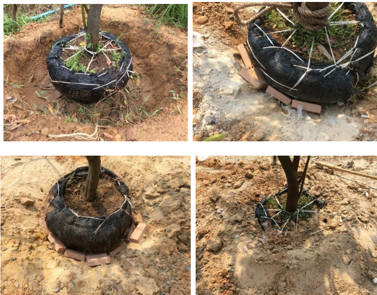
รูปที่ 13 การนำแท่งทดสอบซับน้ำไปใช้ในการวางบริเวณรอบ ๆ ต้นไม้เพื่อซับน้ำ
