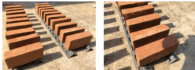
รูปที่ 10 แห้งทดสอบวัสดุซึบน้ำที่ผ่านการอัดบล็อกเรียงบร้อยตากรอการเผา
