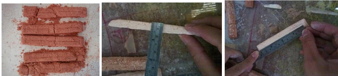
รูปที่ 5 แสดงแท่งทดสอบที่ผ่านการเผาและหาการดูดซึมน้ำ
