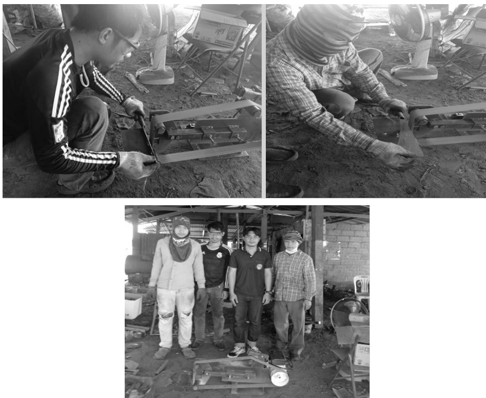
ภาพที่ 3 การทดลองการเจียรระโนด้วยเครื่องขัดกระดาษทรายแบบสายพาน ณ โรงตีมีดบ้านโนนแ่
