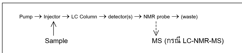
รูปที่ 13 แผนภาพแสดงหลักการของ LC-NMR และ LC-NMR-MS (ดัดแปลงจาก 18 )
