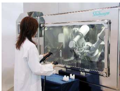
ภาพที่ 6 หุ่นยนต์เตรียมยาเคมีบำบัด 6A) หุ่นยนต์เตรียมยาเคมีบำบัดแบบบังคับแขนกลด้วยมือ 6B) หุ่นยนต์เตรียมยาเคมีบำบัดแบบแขนกลอัตโนมัติ (ดัดแปลงจากเอกสารอ้างอิง 35, 36 )
