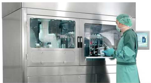
ภาพที่ 6 หุ่นยนต์เตรียมยาเคมีบำบัด 6A) หุ่นยนต์เตรียมยาเคมีบำบัดแบบบังคับแขนกลด้วยมือ 6B) หุ่นยนต์เตรียมยาเคมีบำบัดแบบแขนกลอัตโนมัติ (ดัดแปลงจากเอกสารอ้างอิง 35, 36 )
