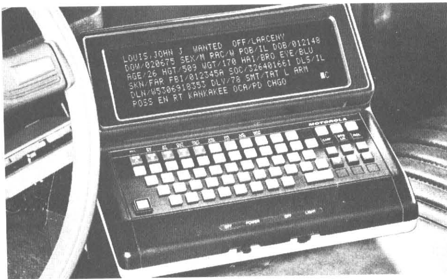
รูปที่ 10 ไมโครคอมพิวเตอร์ ที่มีแผงแสดงเอ้าท์พุท และส่วนป้อนโปรแกรมอินพุท
