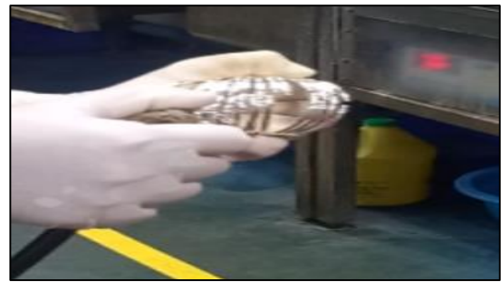
ภาพที่ 3 การเป่าแห้งกำไลหลังการซบกันหมอง (การปรับปรุงวิธีที่ 1 กำหนดทิศทางลม)
