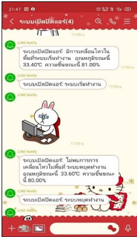
รูปที่ 5 การแจ้งเตือนในกรณีที่ไม่พบการเคลื่อนไหวภายในห้อง
