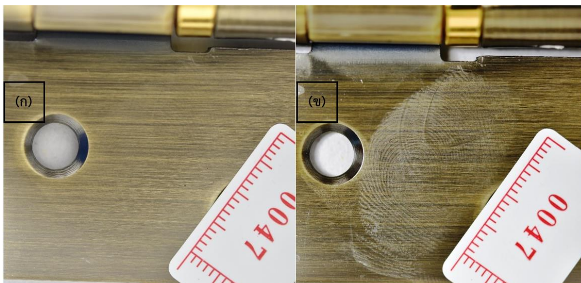
รูปที่ 3 ภาพถ่ายรอยลายนิ้วมือแฝงที่ปรากฏบนพื้นผิวอัลลอยด์เปรียบเทียบกับระหว่าง (ก) ก่อนการหารอยลายนิ้วมือแฝงด้วยวิธี PCS gel กับ (ข) หลังการหารอยลายนิ้วมือแฝงด้วยวิธี PCS gel
