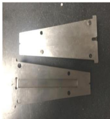
รูปที่ 3 ASTM D790-07 molded material flex bar mold
