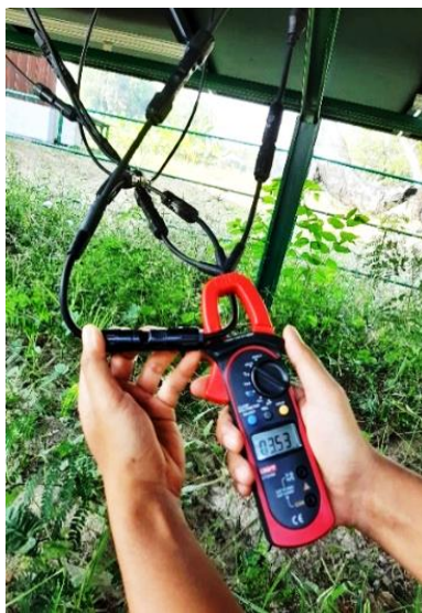
รูปที่ 6 การวัดกระแสไฟฟ้าที่ผลิตได้จากแผงโซลาร์เซลล์
