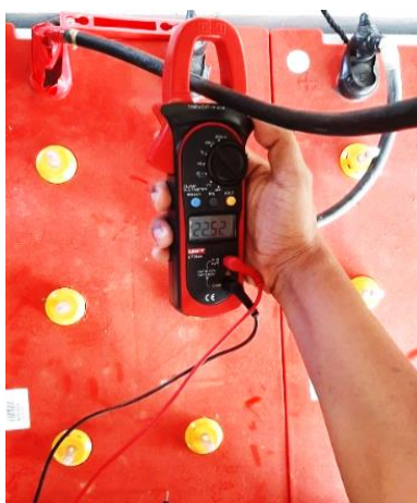
รูปที่ 7 การวัดการชาร์จกระแสไฟฟ้าเข้าสู่แบตเตอรี่
