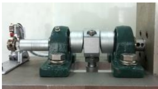
รูปที่ 4 เพลาลูกเบี้ยวทดแม่พิมพ์อัดเม็ดยาสมุนไพรม
