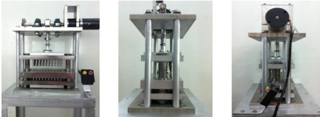
รูปที่ 5 เครื่องอัดเม็ดยาสมุนไพรที่พร้อมเก็บข้อมูล
